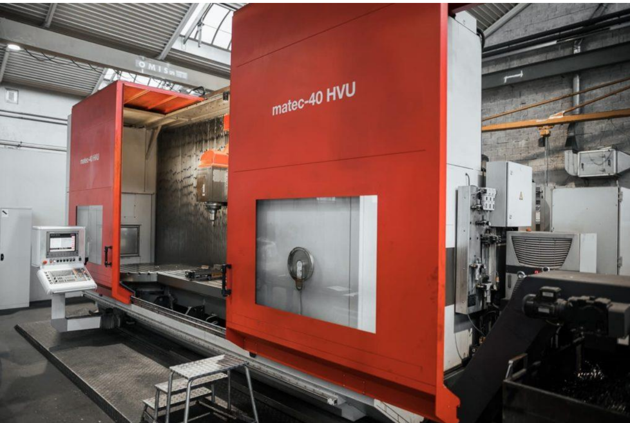
Die MATEC 40HVU mit 2-Achs-Universal-Schwenkkopf für die Einzelfertigung komplexer Bauteile
