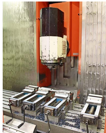
Schraubstöcke dienen zur Anpassung an unterschiedlich große Bauteile.
